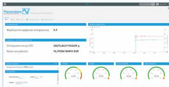
Panel sterowania rozwiązania opartego na technologii chmury wyświetla użytkownikowi różne statusy, rozpoznania, analizy i statusy alarmowe w czasie rzeczywistym.
